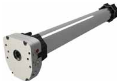
Серия 55M для валов RV70 и RV102 с редуктором аварийного открытия грузоподъемностью до 120 кг
